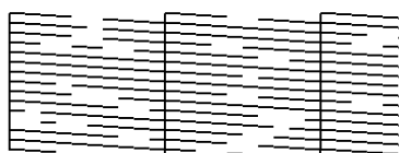
Ejemplo de inyectores obstruidos
